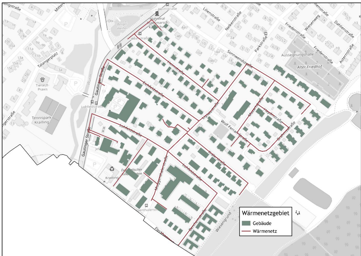
Abbildung 21: Detailbetrachtung Gewerbemischgebiet Süd, möglicher Trassenverlauf eines Wärmenetzes, eigene Darstellung
